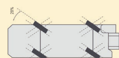
Шарнирное рулевое управление на четыре колеса (4WS), крабовый ход
