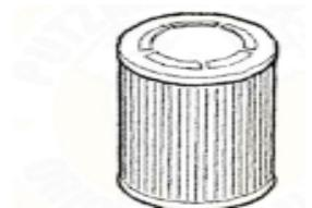
Топливный фильтр с водоотделяющим патроном
