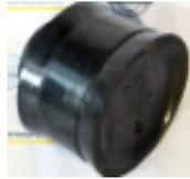
Подающий поршень D-200 мм, цельнолитой
