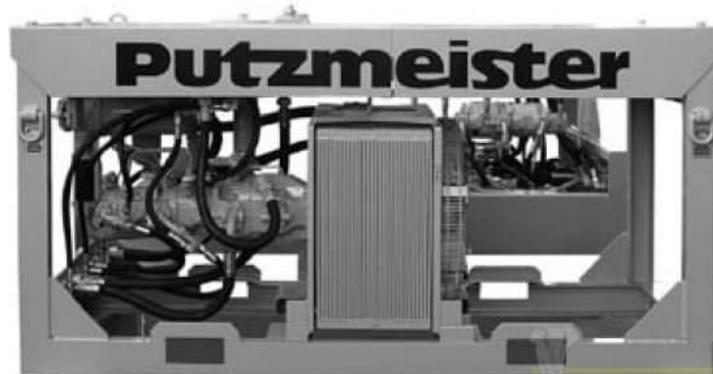
Используемый в конструкции данного насоса S-образный трубчатый шибер с системой автоматического уплотнения позволяет перекачивать даже жидкие тампонажные (инъекционные) смеси.
