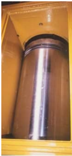
Рис.11 Подающий поршень насоса, фланец загрузочного отверстия
