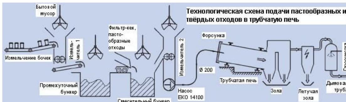
Рис.4 Технологическая схема подачи пастообразных и твердых объемов в трубчатую печь
