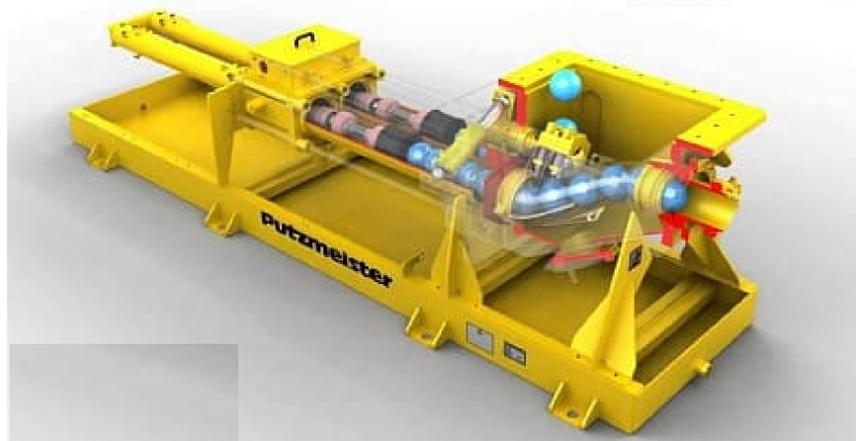
Поршневые гидравлические шламовые насосы KOS с трубчатым S-образным шибером позволяют перекачивать под высоким давлением различные промышленные среды, шламы, пульпу и суспензии с высоким содержанием твёрдой фракции до 65 %, крупностью частиц до 150 мм и более на большие расстояния и высоту свыше 600 м.
